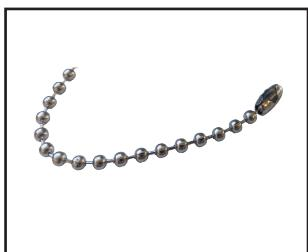
Kugelkette Edelstahl, 200 mm lang, mit Verschluss, Kettenstärke 4,5 mm, Verschlussdurchmesser ca. 5,9 mm
