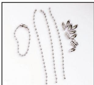
Kugelkette Edelstahl, 200 mm lang, mit Verschluss, Kettenstärke 2,4 mm, Verschlussdurchmesser ca. 3,2 mm
