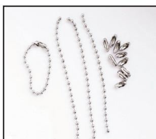
Kugelkette Edelstahl, 300 mm lang, mit Verschluss, Kettenstärke 2,4 mm, Verschlussdurchmesser ca. 3,2 mm
