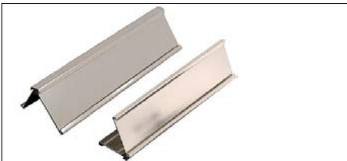
Tischprofil 4, Alu Strangpressprofil, silber eloxiert, Größe 203 mm lang, Dieses Modell ist **mit zwei Einschubmöglichkeiten** ausgestattet, Einschubgröße Groß 203 x 50,6 mm und Einschubgröße Klein 203 x 37,9 mm, maximale Stärke 1,5mm
